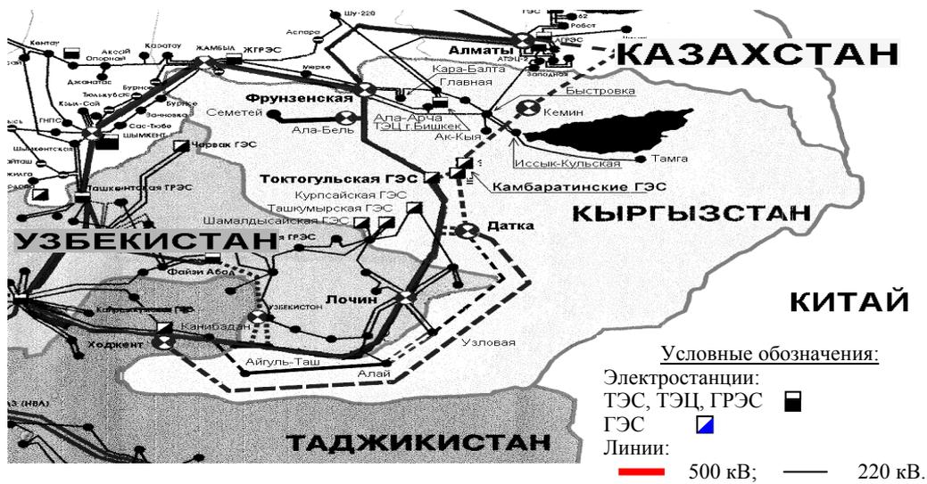
Схема ЭЭС Кыргызстана на напряжениях 220 и 500 кВ.
