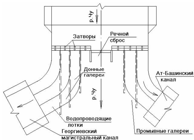
Рис. 4.6 Схема фронтального водозаборного сооружения на примере Чумышского гидроузла.
