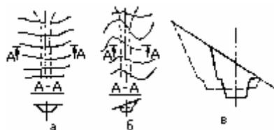
Рис. 7.2. Варианты трассировки оси открытого берегового водосброса по береговому склону: а – перпендикулярно к горизонталям; б – под углом к горизонталям; в – с широким или узким быстротоком.
