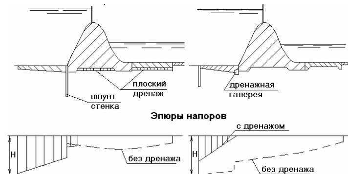
Рис. 3.7. Размещение дренажа по подземному контуру нескального грунта.
