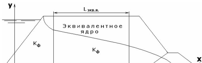
Рис. 5.6. Приведенная схема фильтрации через плотину с ядром.
