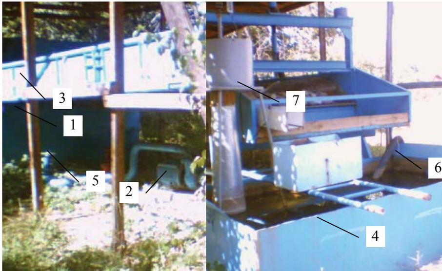
Рис. 1. Общий вид экспериментального стенда: 1 – напорная емкость; 2 – циркуляционный насос; 3 – прямоугольный лоток; 4 – емкость нижнего бьефа; 5 – вентиль напорного резервуара; 6 – гибкий трубопровод; 7 – опытный образец микроГЭС.
