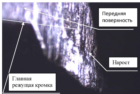
Рисунок 3.9 – Нарост на уголке сверла
